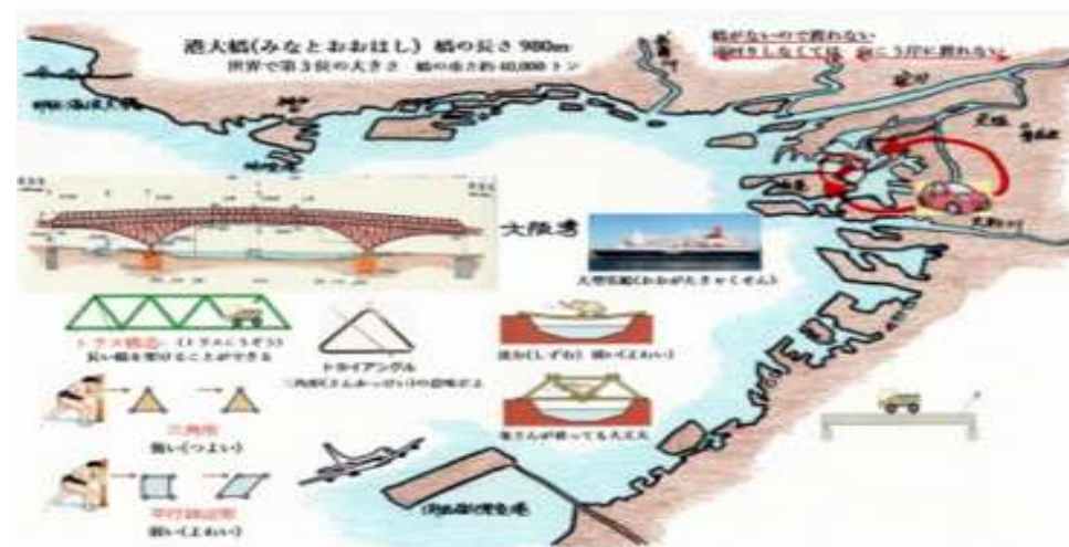
港大橋の位置、トラス橋、トラス構造の特徴
