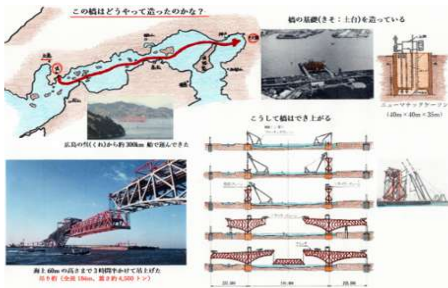
港大橋の工場製作と運搬、基礎の構築、吊り桁一括架設
