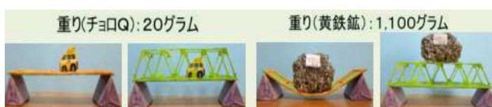
けた橋とトラス橋 どちらが重りに耐えられるかな？ けた橋とトラス橋の載荷実験
