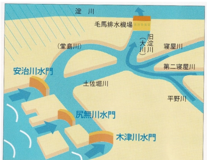
図1 旧淀川筋の防水門方式 2)
