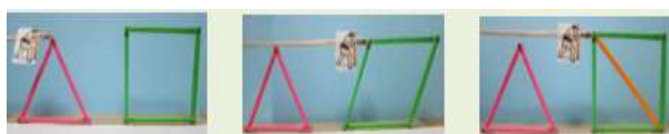
三角形と四角形 横から力を加えるとどうなるかな？ 簡易な模型で三角形と四角形との違いを実験
