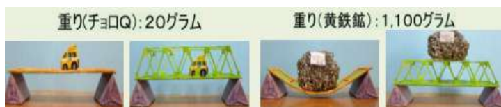
けた橋とトラス橋 どちらが重さに耐えられるかな？ けた橋とトラス橋の載荷実験
