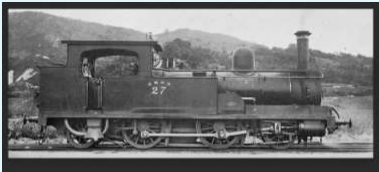
イケヅキ号 英国ダブス社製 2-4-2(1B1)形タンク機 鉄道院500形 製造年 1888-1890・ 1894・1897年 引用:関西鉄道の蒸気機関車
