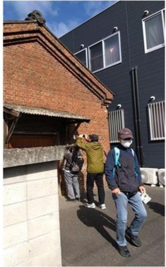
写真-1 ランプ小屋：赤煉瓦作りでオランダ積み
